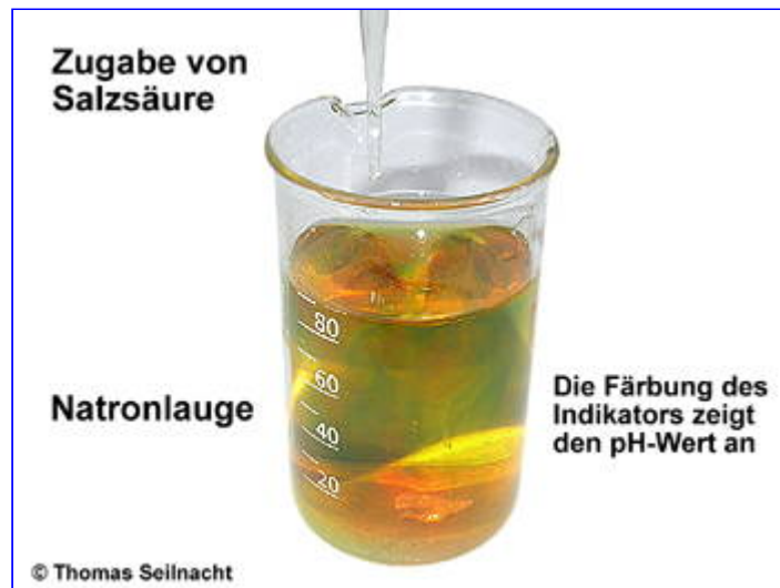
Neutralisation von Natronlauge mit Salzsäure bei einer Titration
